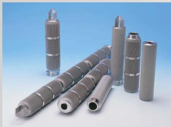
マイクロ・スクリーン™-Eは、オールステンレス製フィルターカートリッジです。焼結金属不織布カートリッジ (ESAタイプ)、焼結金網カートリッジ (ESNタイプ)、非焼結金網カートリッジ (ESMタイプ) の3種類があり、それぞれに洗浄が容易な円筒タイプとろ過面積の大きいプリーツタイプのメディア形状があります。
